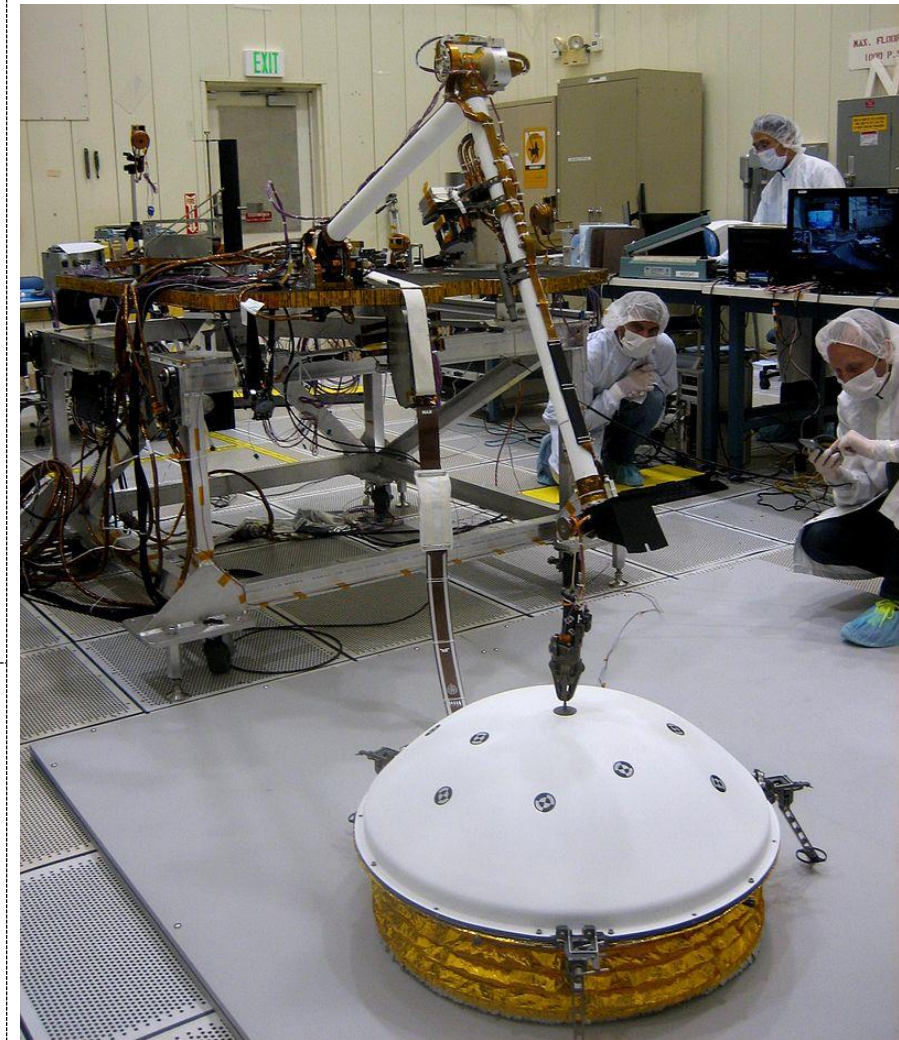
Photo du test de déploiement du sismomètre par le bras robotique d'InSight. (Crédit image NASA/JPL)
