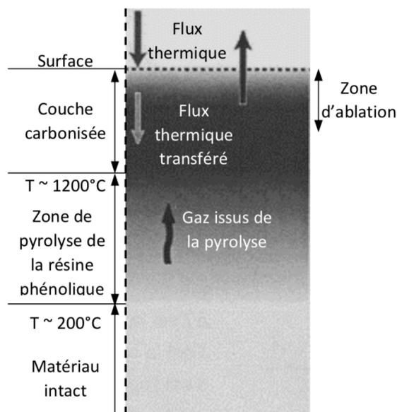
Pour une durée d'ablation de l'ordre de 200 s, la variation d'épaisseur du matériau à la température de 2000°C est de 0,02 mm.s<sup>-1</sup>.
